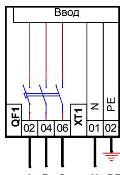
Фазные проводники электропитающего кабеля подключаются к нижним зажимам автоматического выключателя QF1.
